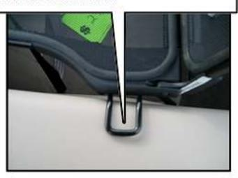
STEP 2 CONT: THE BACK BRACKETS ARE HOOKS THAT ATTACH TO THE SIDE TRIM PANEL NEAR THE BACK SEAT.
